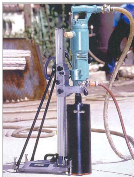
Použití vrtacího stojanu pro vrtání asfaltové vozovky
